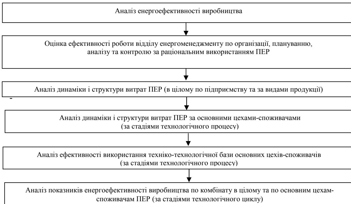
Рис. 2. Послідовність проведення аналізу енергоефективності виробництва в умовах діяльності ГЗК
