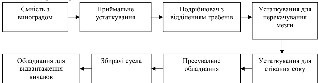
Рис. 2. Технологічна схема переробки винограду за білим способом
