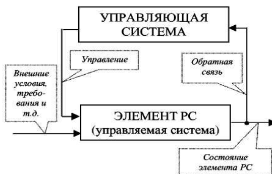
Рис. 2. Структура системы управления элементом РС
